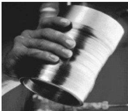
Gambar 2.12 Keausan pada mechanical seal
