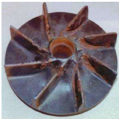
Gambar 3.3 Dampak fenomena cavitasi pada impeller pompa
